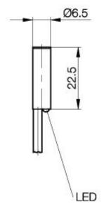
Induktiver Näherungsschalter BES 516-371-SA 10-PU-03 D6.5 x 22.5 Schließer Sn=1,5mm bündig einbaubar
